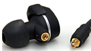
● 写真1: ケーブル着脱式イヤホン(金色の部分が、コネクタ)
