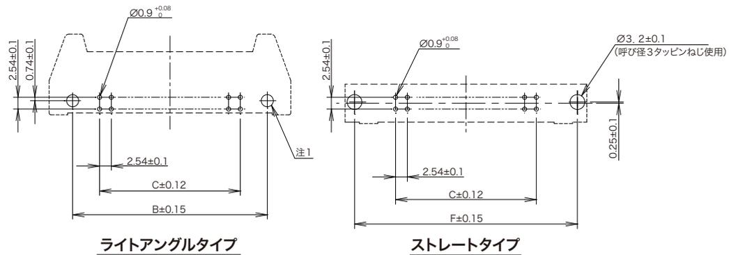
注1 ライトアングルタイプの基板取り付け穴径は、M2.6のネジを使用する時にはØ2.8、呼び径3のタッピングねじを使用する時にはØ3.2となります。
