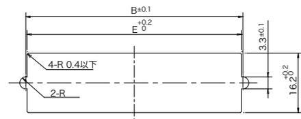
適合パネル取付穴参考寸法(コネクタ後面取付時)
