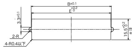
適合パネル取付穴参考寸法(コネクタ後面取付時)
